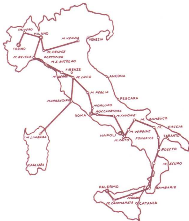
Fig. 4 — Il percorso del ponte radio televisivo Milano—Palermo
